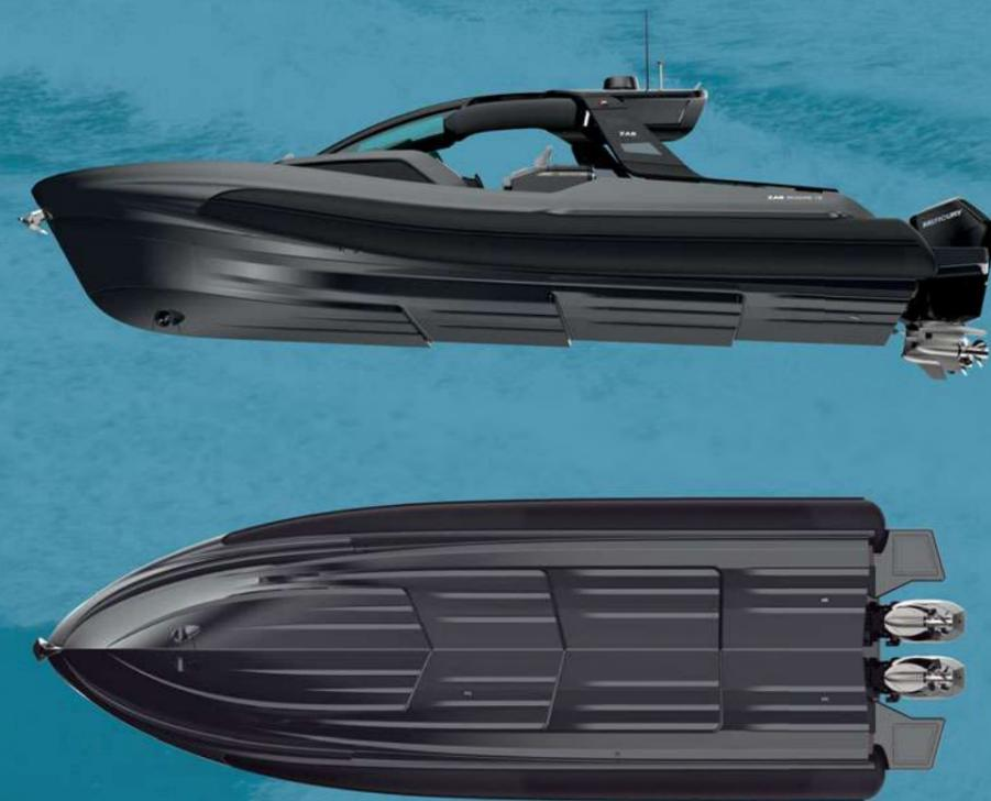
Disegnata da Francesco Ambrosini la rivoluzionaria carena a steps sia longitudinali che laterali, caratteristici tunnel idrosostentanti, "V" profonda e ruota di prua caratteristica ZAR.
